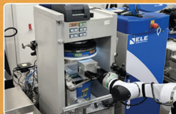
Automated Concrete Cube Testing System 自動混凝土磚測試系統
